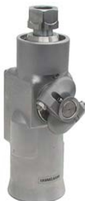
Tipo L 1200-2 con carcasa para limpieza de tuberías, portaboquilla en "S" de 18 mm, 2 boquillas Max. 1200 bar / max. 200 l/min. Min. Ø acceso al tubo: 210 mm
