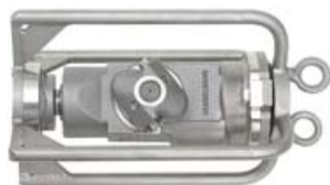
Tipo L 1200-2 con carcasa para limpieza de tuberías, portaboquilla en "S" de 18 mm, 2 boquillas Max. 1200 bar / max. 200 l/min. Min. Ø acceso al tubo: 210 mm
