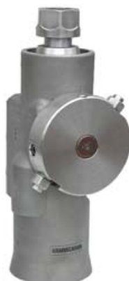
Tipo L 1200-2 portaboquilla en "S" de 18 mm, 2 boquillas Max. 1200 bar / max. 200 l/min. Min. Ø acceso al tanque: 140 mm
