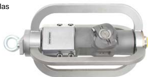
Tipo XL 1600-2 con carcasa para limpieza de tuberías, portaboquilla en "S" de 35 mm, 2 boquillas Max. 1600 bar / max. 250 l/min. Min. Ø acceso al tubo: 320 mm
