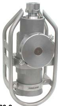
Tipo XL 1600-2 portaboquilla en "V" de 13 mm, 2 boquillas Max. 1600 bar / max. 250 l/min. Min. Ø acceso al tanque: 190 mm
