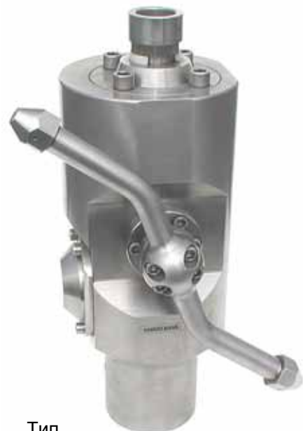
Тип XXL 1600-2 56 мм плечо, 2 плеча макс. 1600 бар / 500 л/мин. Минимальное входное отверстие ёмкости: 500 мм
