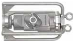
Тип L 1200-2 с направляющими салазками для труб и трубных колен 18 мм S-плечо, 2 сопла макс. 1200 бар / 200 л/мин. Минимальный диаметр трубы: 210 мм
