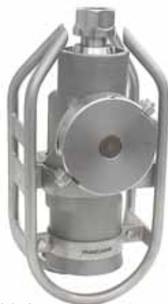
Тип XL 1600-2 13 мм V-плечо, 2 сопла макс. 1600 бар / 250 л/мин. Минимальное входное отверстие ёмкости: 190 мм
