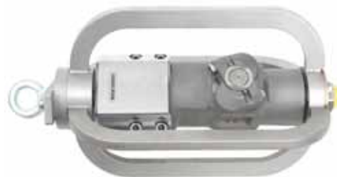
Тип XL 1600-2 с направляющими салазками для очистки труб 35 мм S-плечо, 2 сопла макс. 1600 бар / 250 л/мин. Минимальный диаметр трубы: 320 мм
