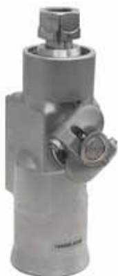
Тип L 1200-2 с направляющими салазками для труб и трубных колен 18 мм S-плечо, 2 сопла макс. 1200 бар / 200 л/мин. Минимальный диаметр трубы: 210 мм
