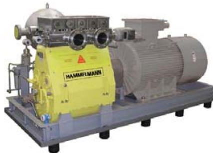
Pumpen-Aggregat HDP 755 Fördern von Lagerstättenwasser Temperatur: 158° F / 70°C Chloride: 140.000 ppm Betriebsdruck 3050 psi - 210 bar Fördermenge 438 gpm - 1660 l/min
