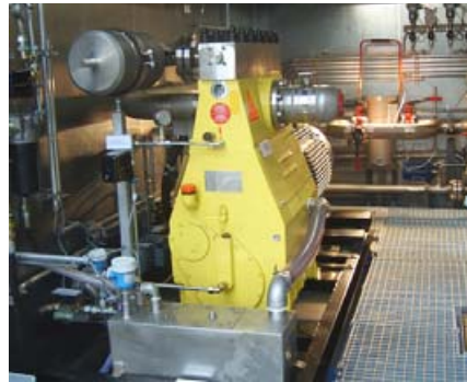
Pumpen-Aggregat HDP 257 Fördern von Lagerstättenwasser Temperatur: 95° F / 35°C Chloride: 15.000 ppm Betriebsdruck 1160 psi - 80 bar Fördermenge 200 gpm - 760 l/min
