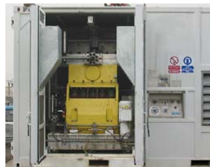
Pumpen-Aggregat HDP 755 Fördern von Lagerstättenwasser Temperatur: 149° F / 65°C Chloride: 110.000 ppm H 2 S: 190 ppm Betriebsdruck 6200 psi - 430 bar Fördermenge 150 gpm - 570 l/min
