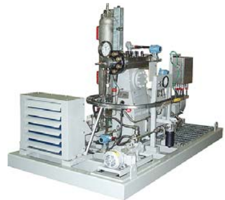
Pumpen-Aggregat HDP 125 Fördern von Lagerstättenwasser Temperatur: 212° F / 100°C Chloride: 180.000 ppm H 2 S: 6.100 ppm Betriebsdruck 1800 psi - 125 bar Fördermenge 45 gpm - 170 l/min
