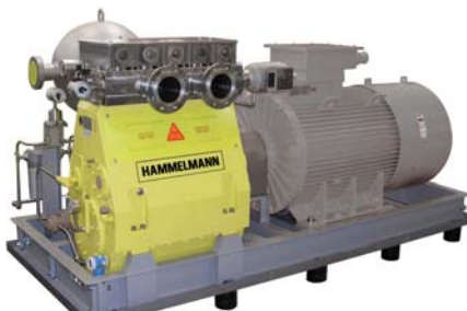
HDP 755 - Lagerstättenwasser Betriebsdruck 212 bar Fördermenge 1660 l/min
