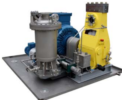
HDP 175 - Acrylsäure Betriebsdruck 2500 bar Fördermenge 13 l/min
