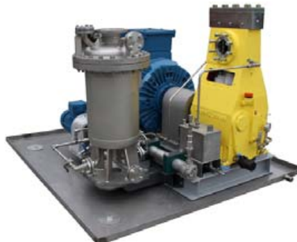
HDP 175 - Acrylsäure Betriebsdruck 2500 bar Fördermenge 13 l/min
