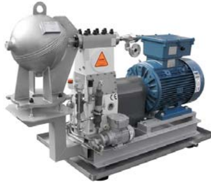
HDP 75 - Abwasser Betriebsdruck 160 bar Fördermenge 83 l/min
