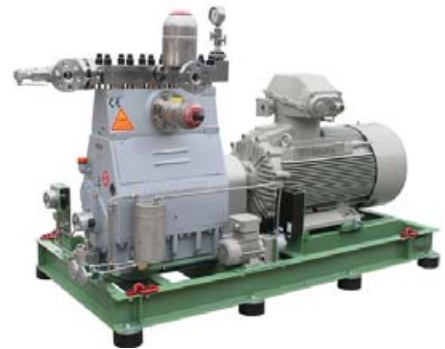
HDP 255 - Methanol Betriebsdruck 285 bar Fördermenge 250 l/min
