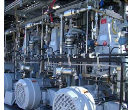
2 Pumpen-Aggregate HDP175 zum Fördern von Methanol Betriebsdruck 5,300 psi - 370 bar Fördermenge 46 gpm - 176 l/min
