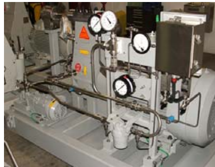
Pumpen-Aggregate HDP72 zum Fördern von Methanol Betriebsdruck 12,000 psi - 830 bar Fördermenge 6 gpm - 24 l/min
