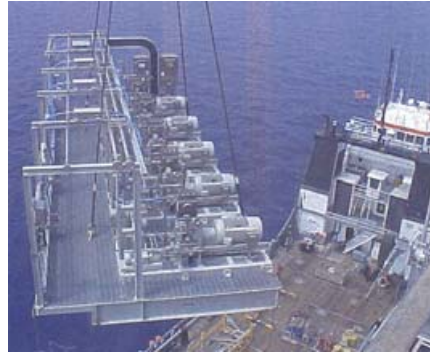
5 Pumpen-Aggregate HDP115 zum Fördern von Methanol Betriebsdruck 15,000 psi - 1035 bar Fördermenge 1.5 gpm - 6 l/min
